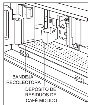
Bandeja recolectora y recipiente de residuos de café molido
