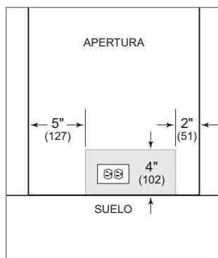
Ubicación del suministro eléctrico
